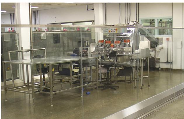
Instalado em conjunto com os biombos vítreos, os Bate Pallets, são protetores de impacto fabricados em tubos de aço inox. Sua função é proteger a divisória ou biombo de impactos provenientes da operação da área (movimentação de empilhadeiras, paleteiras, carrinhos de serviço, etc.).
